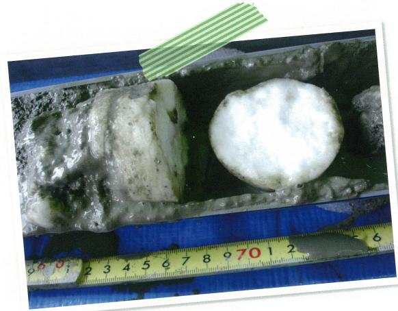
氷は電気を通しにくいのだから、海底で電気探査を行なってメタンハイドレートを見つけよう！という試みが日本海で行なわれました。その結果、地中に電気を通しにくい地層が新たに見つかり、その一部はメタンハイドレートであることが海底で採取した泥から確認できました。この結果に基いて地下の断面図を求めたところ、地中で柱状にそそりたつメタンハイドレートの存在が明らかになりました。地下資源を効率良く探すためには、このような新しい探査技術の開発が必要です。
